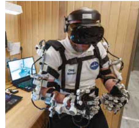
Олег в эксперименте по дистанционному управлению роботизированными руками при поддержке VR-системы
